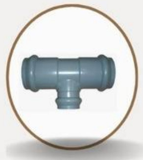
Te de PVC reducida Inyectada con aro de goma Clase 10
